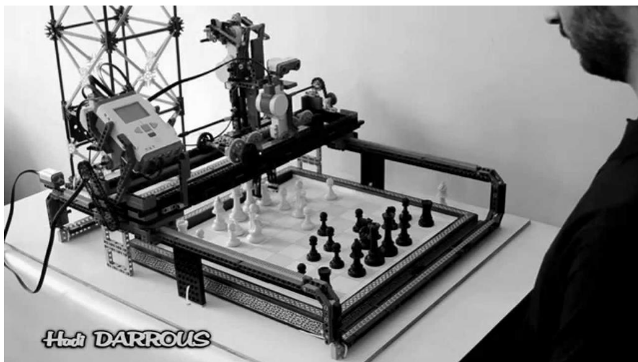
En skakspillende robot, et Lego Mindstorm-projekt af Hodi Darrous
